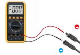
Figura 3.22 Medición con multímetro
