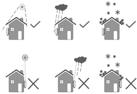
FIG.6-1 Posições de instalação do inversor
