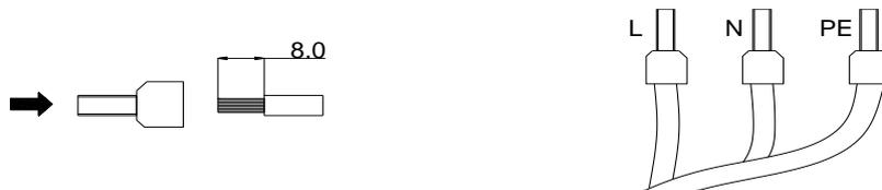
FIG. 7-4 Crimpagem da ponteira de três núcleos
