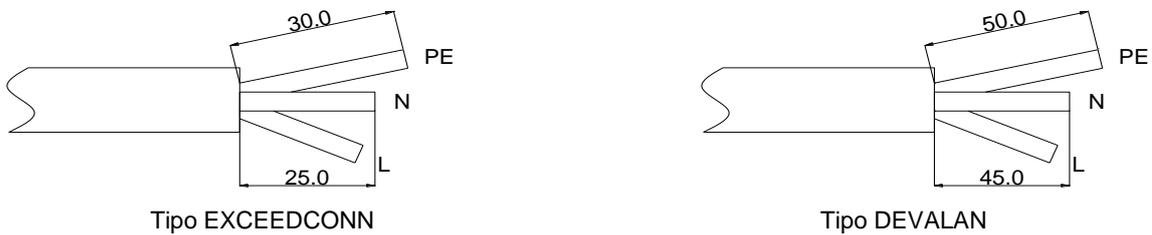
FIG. 7-3 Ajuste o comprimento do cabo
