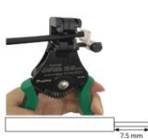
FIG.7-11 Tira a camada isolante do cabo
