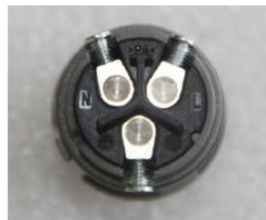
▲Figura 4.13 Interior do conector do terminal de rede CA
