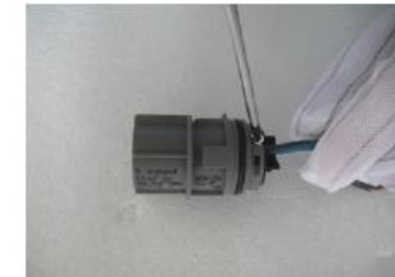
▲Figura 4.16 Conexão dos fios aos terminais
