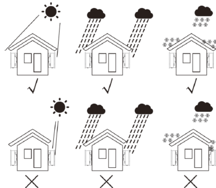
▲ Figura 4.1 Locais recomendados para a instalação
