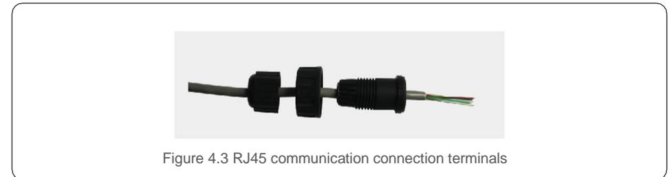
2. Utilice el pelacables de red para pelar la capa de aislamiento del cable de comunicación. De acuerdo con la secuencia de línea estándar de la figura 4.4, conecte el cable al enchufe de RJ45 y luego use una herramienta de engarzado de cables de red para apretarlo.
