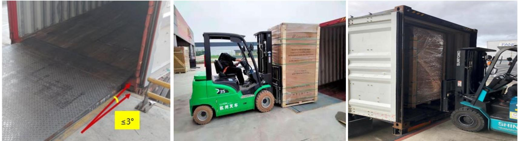
El fondo del contenedor y la plataforma de carga y descarga deben estar al mismo nivel y el ángulo de inclinación debe ser  $\leq 3^\circ$ .
