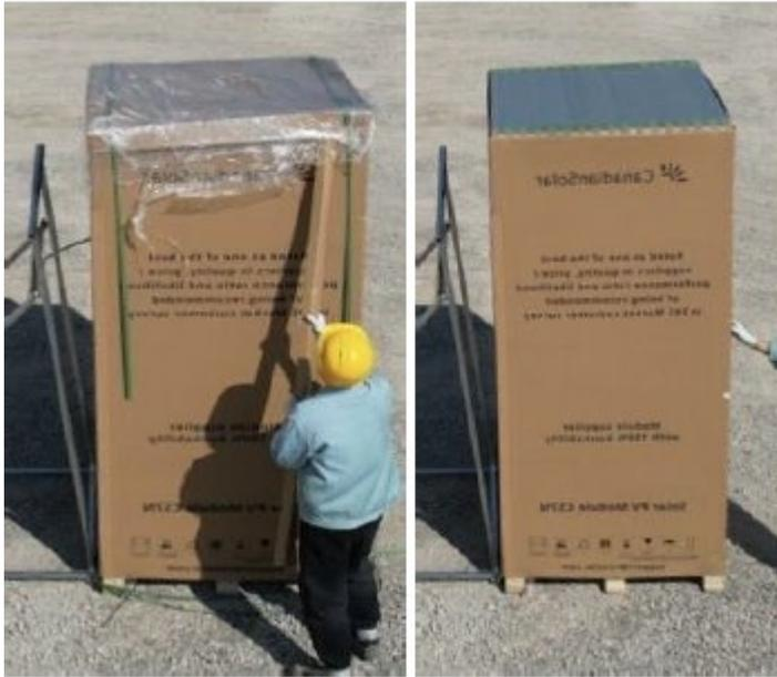
Retire las vigas de papel en las esquinas de la paleta, luego use la viga de papel para quitar la tapa superior y la envoltura de plástico.
