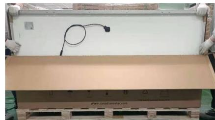
Dois trabalhadores retiram as fitas adesivas nas duas extremidades de um módulo uma vez por vez, e as fitas precisam ser enroladas conforme a imagem acima.
