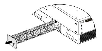
Figure 6-3 Pull out fan module
