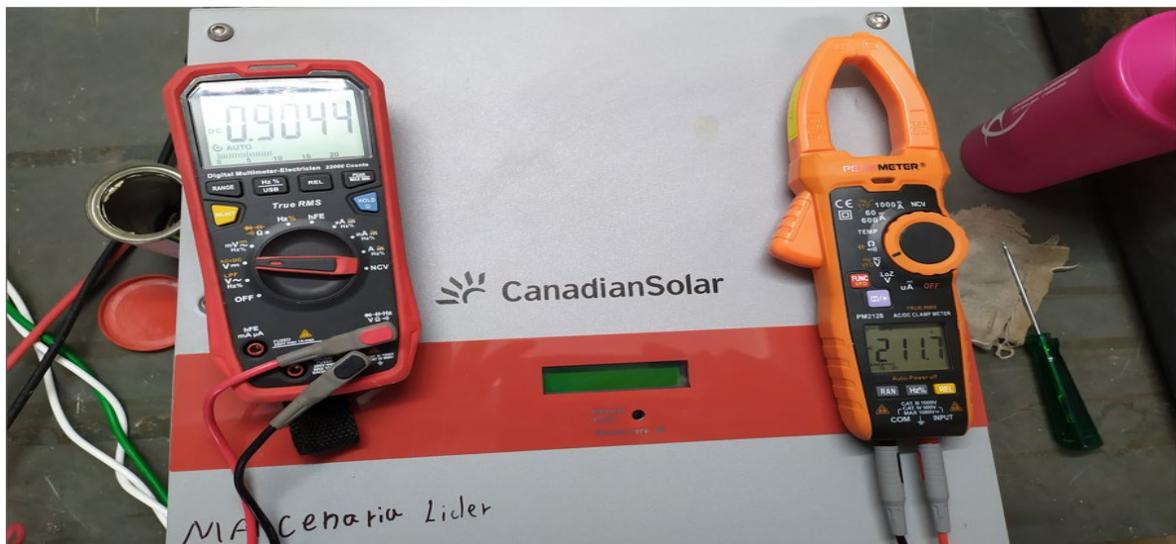
Medição de PV+ para Terra com fuga de tensão:
