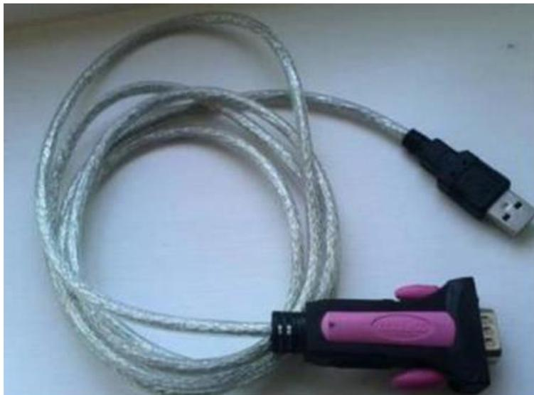
**2.** Verifique o número da porta COM gerada no Gerenciador de Dispositivos do seu laptop. A porta COM só pode ser criada quando você conectar o cabo conversor USB para RS232 em seu laptop e o driver para o cabo for instalado com sucesso, caso contrário não haverá porta COM mostrada no Gerenciador de dispositivos, ou haverá um ponto de interrogação amarelo ou ponto de exclamação no ícone da porta COM.
