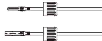
▲ Figura 4.12 Crimpe o pino de contato com o fio
